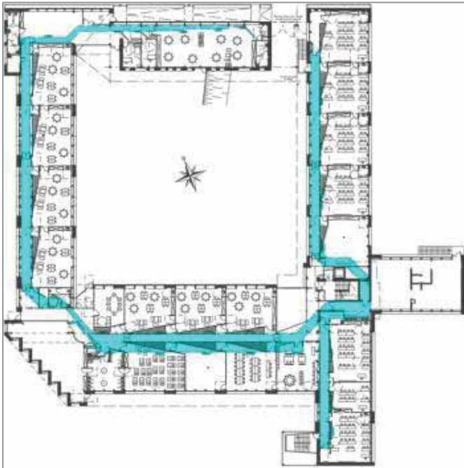
Le système d'extraction douce naturelle, appliquée en horizontal.
