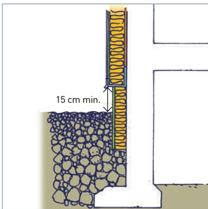
Pose du bardage ou de l'enduit à l'abri de l'humidité du sol : il faut un espace de minimum 15 cm entre le bardage ou l'enduit et le sol extérieur. Sur les 15 premiers centimètres au-dessus du niveau du sol extérieur, un isolant imputrescible et hydrophobe est placé. Cet isolant est également prolongé plus ou moins profondément dans le sol en fonction du niveau de la dalle de sol intérieure. Cet isolant doit être protégé par un matériau étanche à l'eau.
