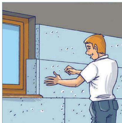
Veillez à ce que les éléments de la fenêtre soient adaptés à l'isolation des murs par l'extérieur :
