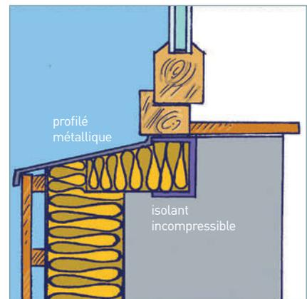
Un profilé métallique a remplacé l'ancien seuil en pierre afin de permettre le placement d'un isolant incompressible sous le châssis existant.
